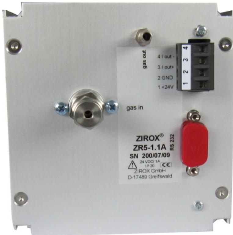
**Abb. 3:** Rückseite des ZR5-Moduls
