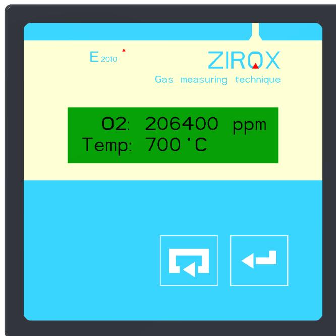
Abbildung 7: Frontansicht E2010 mit Tasten und Display
